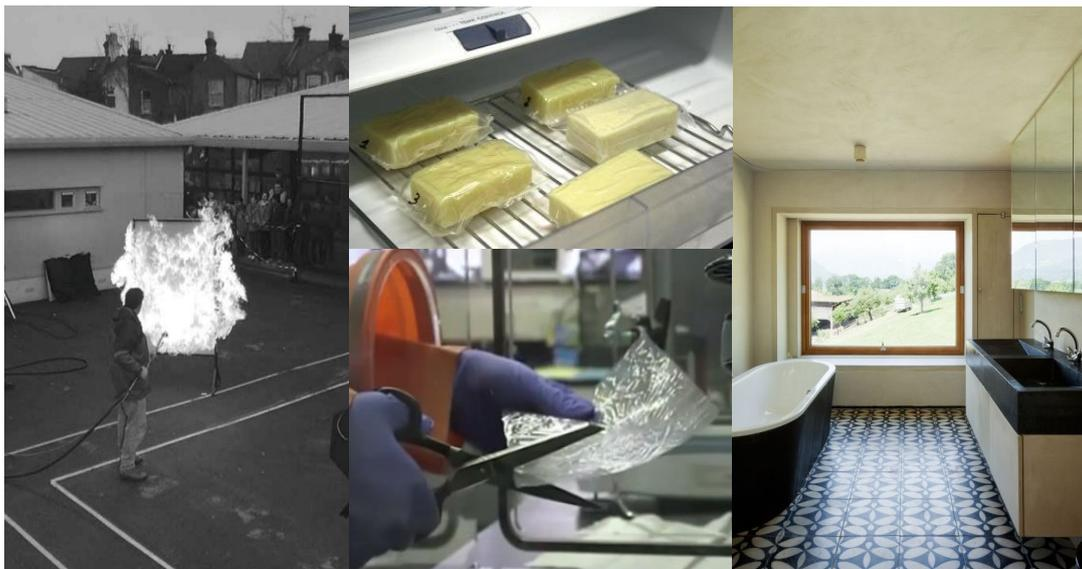
Abbildung 15: (V l n r) Brandversuche, Schutzschichten in der Verpackungsindustrie und Beispiel einer proteinbasierten Schutzschicht im Lehm- und Ziegelbau im Haus Rauch (Boltshauser Architekten). Dort wurde eine Lehm-Kasein-Spachtelung angeschliffen, mit Leinöl imprägniert und mit dem Wachs aus der brasilianischen Carnaubapalme poliert, welches als das härteste bekannte natürliche Wachs gilt. Dadurch wird die Oberfläche wasserfest, hart und pflegeleicht.
